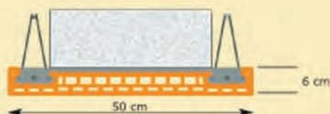
Pannello in sezione sulla nervatura trasversale
