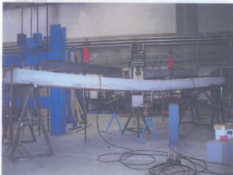
Fotografia 9: Pannello da 150 cm sotto carico massimo
